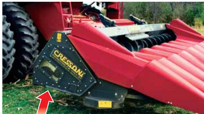
Боковые цепи передачи находятся в масляной ванне.
